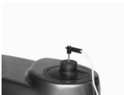
Рис. 4.20. Установка электрода в стаканчик
