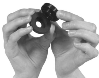
Рис. 4.17. Соединение диэлектрических частей фиксатора для стеклянного стаканчика
