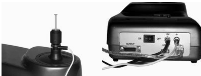
Рис. 4.12. Подключение «единого заземления» к держателю и прибору
