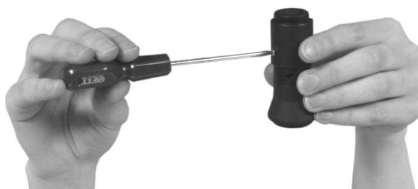
Рис. 4.9. Регулировка высоты при фиксации винта на корпусе держателя
