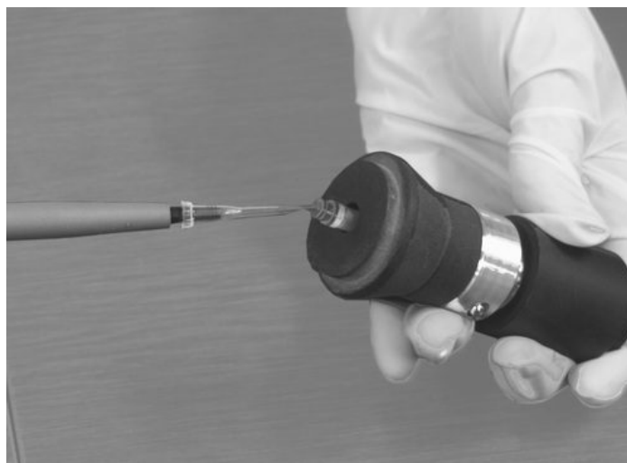
Рис.5. Нанесение микродозатором капли исследуемой крови на поверхность насадки лабораторного шприца.
