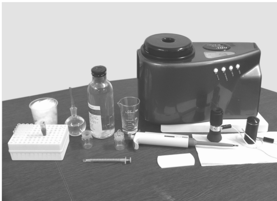
Рис.2. ГРВ «Камера» с набором лабораторных инструментов для измерения жидкостей.
