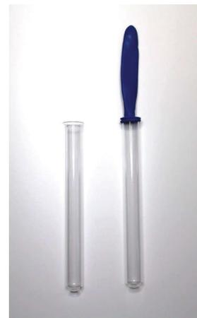
Рис. 3. Пробирка с резиновым индикатором давления.
