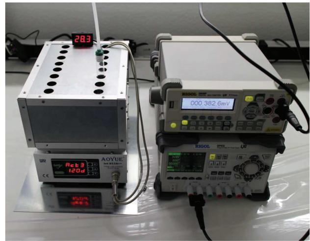
Рис. 5. Установка для калибровки резиновых индикаторов давления с сенсором Honeywell 26PCCFA6G ( $V_{CC}=15V$ ).
