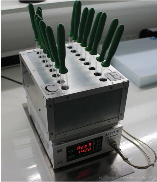
Рис. 4. Металлический контейнер с 8 контрольными и 8 экспериментальными популяциями, установленный на нагревателе.
