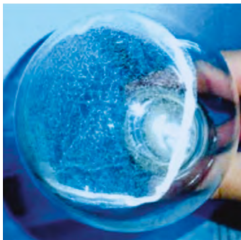
Рисунок 36. Твердый осадок, остающийся после замораживания и сушки 250 мл воды, обработанной Нафионом.
